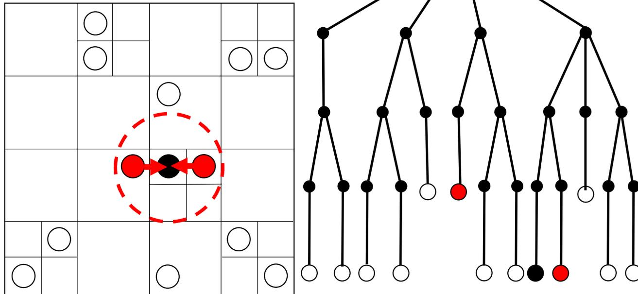
ツリーをたどり、ツリーセルが力を計算したい粒子から十分遠ければ、ツリーをたどるのをやめる。近ければ更に深く探査する。
